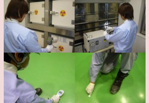
左上/空間線量率測定 右上/空気中放射性物質濃度測定 左下/表面密度測定(直接法) 右下/表面密度測定(間接法)
