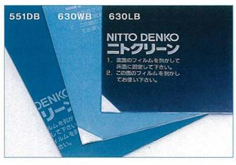
マットの上を歩くだけで、靴の裏や運搬車のタイヤに付着している細かいチリやホコリを除去。ニトクリーンは、すぐれた除塵効果をもつ粘着フィルムを積層した除塵用マットです。カラーはブルーを基調にした3種をラインアップ。粘着加工を施した薄いフィルムを貼り重ねた構造で、汚れたフィルムを1枚ずつはがせば、最後の1枚まで無駄なく使用できます。
