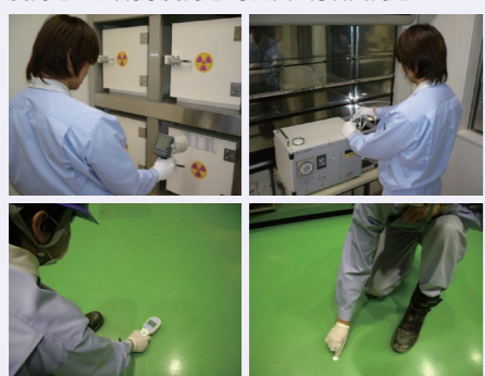
左上/空回り線量率測定 右上/空気中放射性物質濃度測定 左下/表面密度測定 (直接法) 右下/表面密度測定 (間接法)
