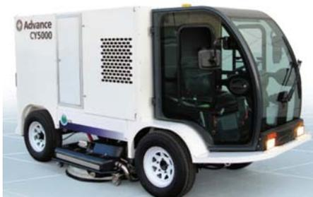
洗浄水供給タンク、回収タンク(各1トン)及び高圧洗浄ヘッド(洗浄幅約80cm)が一体となった車両タイプの高圧洗浄装置です。小型特殊車両として登録が可能です。位置の分散した小・中規模現場、大規模現場において効果を発揮します。
