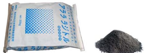
回収した洗浄水から、汚染物を分離します。本剤は高分子凝集剤と無機系凝集剤をバランスよく配合しており、様々な成分を含む処理水に適用することができます。凝集剤の投入から沈殿完了までの処理時間が極めて短く、繰り返し凝集沈殿処理が可能であることから、小規模現場においても効率良く排水処理を行うことができます。
